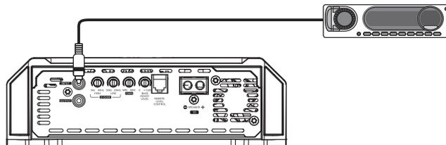
Exemplo de conexão de dois cabos RCA (entrada mono).
