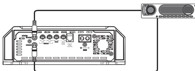
Exemplo de apenas uma conexão de cabo RCA e usando a saída RCA para conectar outro amplificador.
