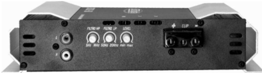
**ENTRADA RCA:** Conecte a entrada RCA à saída do CD/MP3- Player. Verifique se o aterramento do aparelho está correto. Falta de terra é a principal causa de ruído no sistema de som. Utilize cabos RCA SOUNDIGITAL para garantir a melhor qualidade de áudio. **Observação:** O sistema de entrada RCA é estéreo, portanto existe a mixagem dos dois canais internamente.
