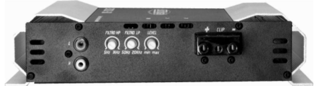
**HI PASS FILTER:** O HP FILTER é ajustável de 5Hz até 1kHz e corta as freqüências abaixo do valor ajustado no potenciômetro. Este filtro possui corte de 12dB/8ª.
