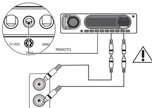
Todas as entradas RCA devem ser conectadas para que o amplificador funcione adequadamente.
