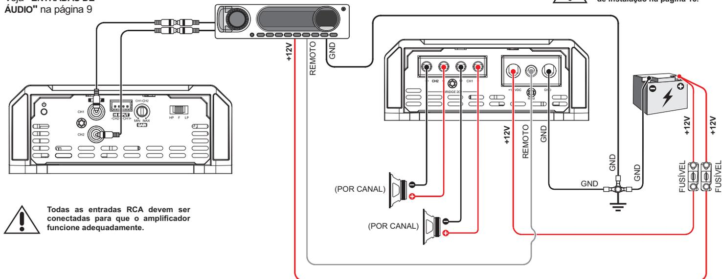
Todas as entradas RCA devem ser conectadas para que o amplificador funcione adequadamente.
