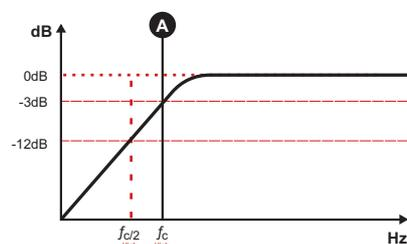
Establezca en el control variable "LOW" entre 50Hz y 20kHz ("B") donde desea realizar el filtro de corte de pasa baja.
