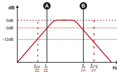
Para configurar el control variable "SUBSONIC" entre 8Hz y 80Hz ("A") donde desea realizar el filtro de corte subsónico;
