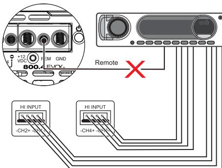
Todas las entradas Altas de audio deben estar conectadas para que el amplificador funcione correctamente.
