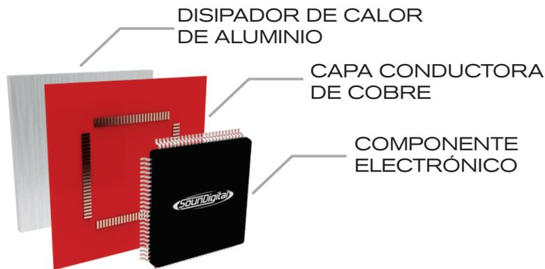
El **DTM**\* es un sistema dinámico de recuperación térmica que mantiene siempre una alta eficiencia del amplificador acelerando el intercambio térmico de los componentes electrónicos con el disipador.
