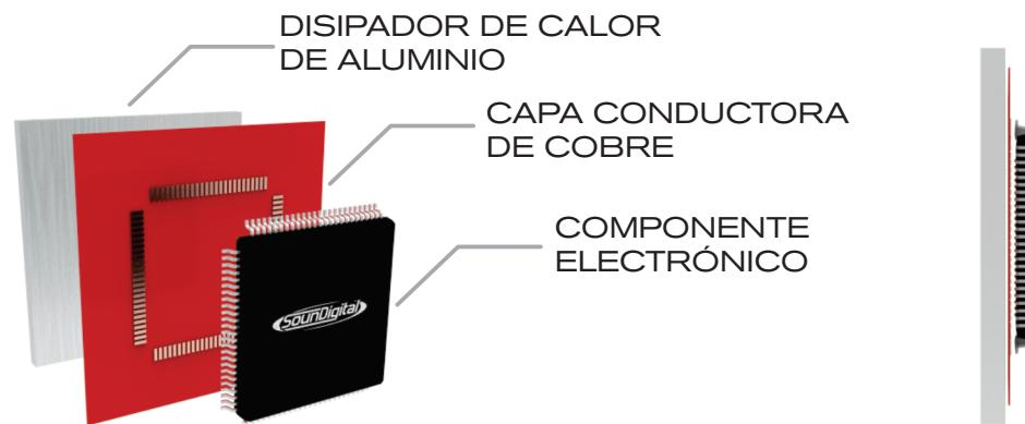
El **DTM\*** es un sistema dinámico de recuperación térmica que mantiene siempre una alta eficiencia del amplificador acelerando el intercambio térmico de los componentes electrónicos con el disipador.
