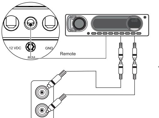
Todas las entradas RCA deben estar conectadas para que el amplificador funcione correctamente. Si la fuente de la señal es de tipo mono, use un cable "Y" en la entrada.
