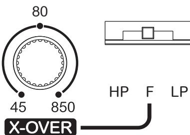
"HP" Define el control de la variable en la función de High Pass.
