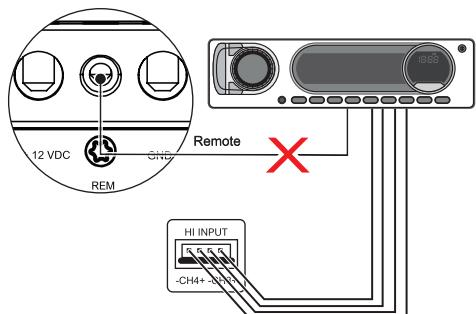
Todas las entradas Altas de audio deben estar conectadas para que el amplificador funcione correctamente.
